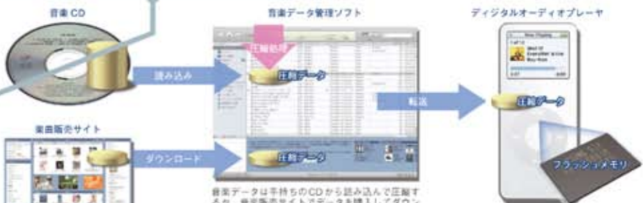
図1 デジタルオーディオプレーヤへの音楽データの転送方法
